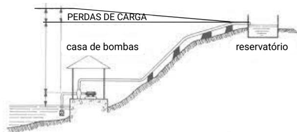
Representação esquemática de uma estação elevatória<sup>1</sup>
