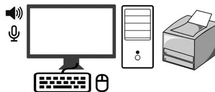
Com componentes internos (instalados na unidade de sistema) e componentes externos (periféricos), os computadores desktop evoluíram em capacidade de processamento, memória, armazenamento e recursos.
