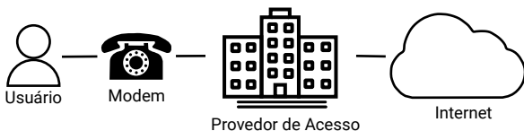
Figura 1. Para acessar a Internet, o usuário utiliza um modem que se conecta a um provedor de acesso através de uma linha telefônica
