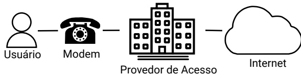
Figura 1. Para acessar a Internet, o usuário utiliza um modem que se conecta a um provedor de acesso através de uma linha telefônica
