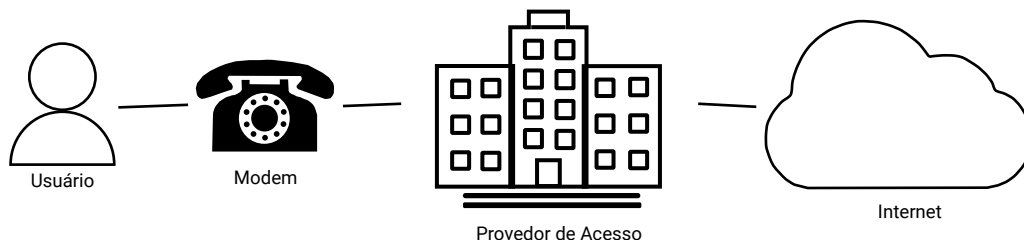
Figura 1. Para acessar a Internet, o usuário utiliza um modem que se conecta a um provedor de acesso através de uma linha telefônica
